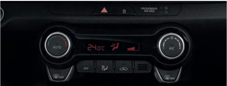
Ar condicionado totalmente automático (FATC) O FATC oferece uma função de "definir e esquecer", que liga e desliga automaticamente este sistema para manter a temperatura desejada no habitáculo.
