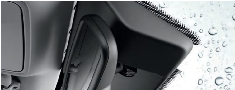
Sensor de chuva. Quando deteta pingos de chuva no para-brisas, o sensor de chuva ativa imediatamente as escovas do limpa para-brisas.
