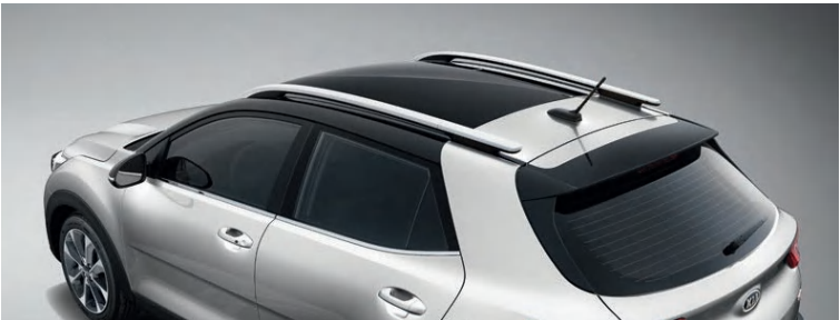
Barras de tejadilho em forma de ponte. Com uma generosa capacidade de 70 kg, estas barras de tejadilho transportam bagagens, equipamentos para a prática de desporto ou objetos volumosos com toda a segurança, mantendo assim o interior espaçoso e protegendo os estofos da sujidade e da humidade.
