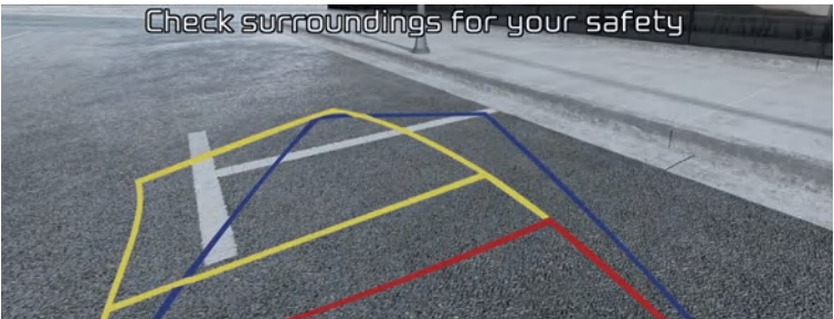
Monitorização do Trânsito na Retaguarda com auxílio ao estacionamento. Projeta indicações dinâmicas no ecrã de 8" do tablier.
